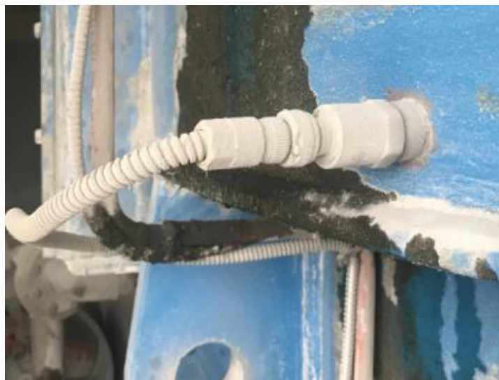
图3 某厂安装在现场的振动传感器
